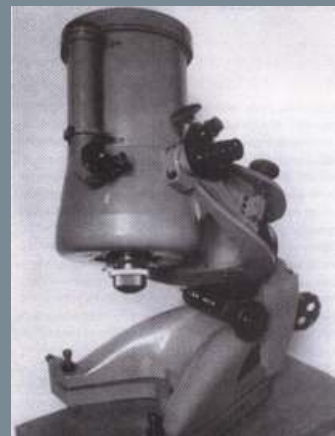
Telescop MTM-1, 8-inch f/7. Cinci instrumente de acest gen au fost realizate la GOI între anii 1944 - 1946.
